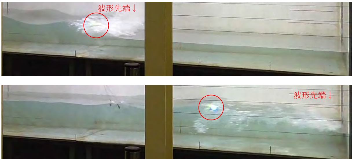
図- 10.2 Wd30 と Wd40 の漂流開始時状況の比較 (初期位置 2.0m, 堤体位置 0m)
