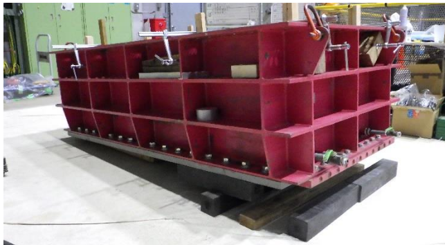
写真 A-1 ソイルモルタル打設時の土槽の設置状態
