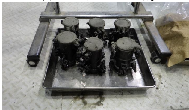
写真 A-3 ソイルモルタルテストピース作製状況
