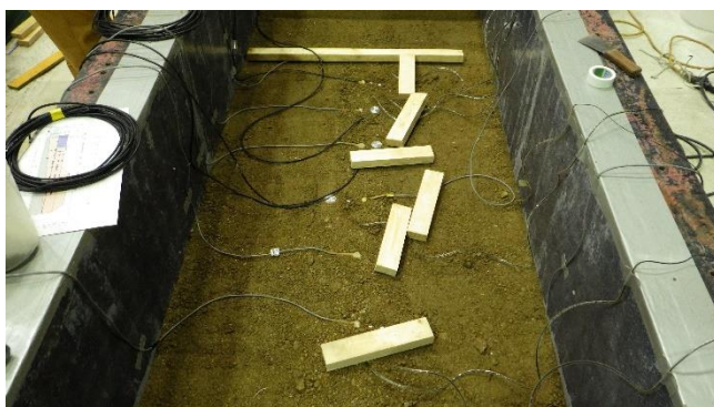
写真 A-7 センサー類設置状況
