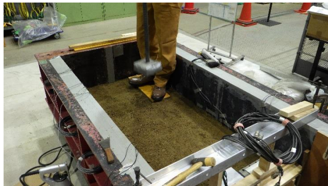
写真 A-6 礫質土層の突き固め棒による締め固め
