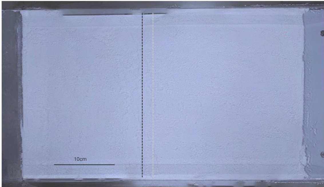
図 2-88 鉛直変位量 2mm のオルソ画像。灰色点線は模擬地盤底盤の断層ブロック境界、黒色点線は断層の地表投影位置。
