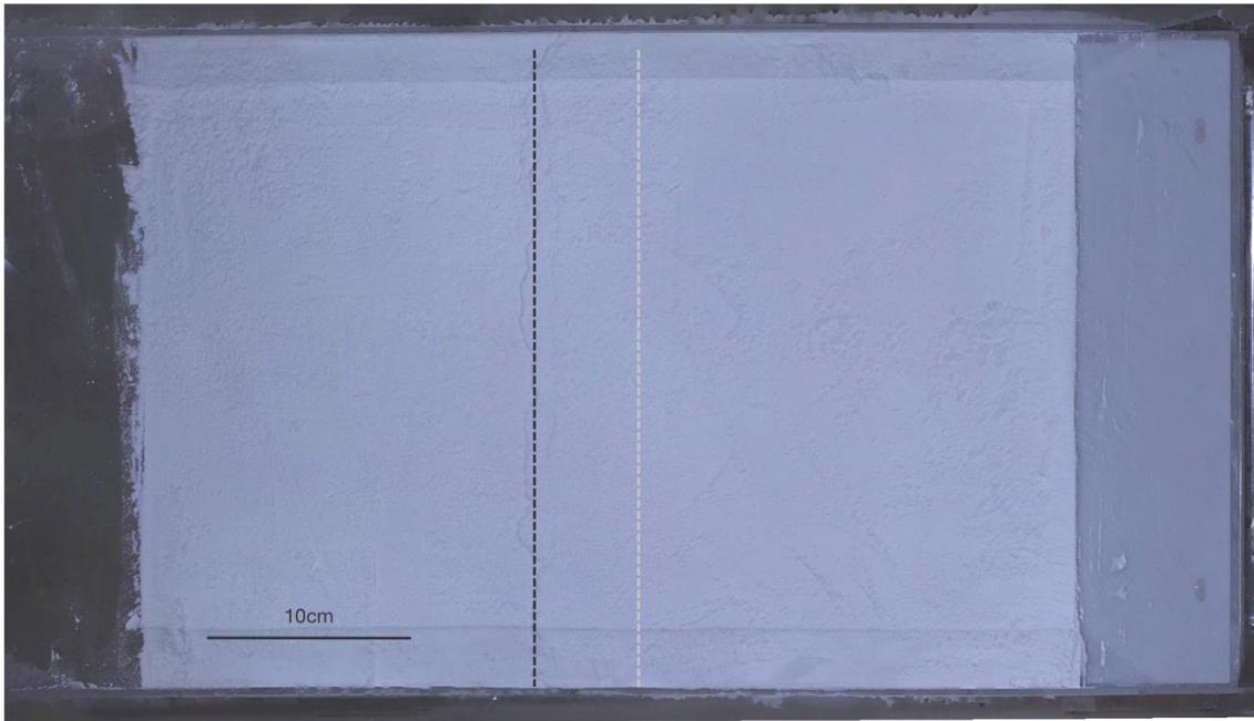
図 2-62 鉛直変位量 3mm のオルソ画像。灰色点線は模擬地盤底盤の断層ブロック境界、黒色点線は断層の地表投影位置。
