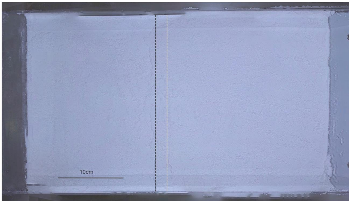
図 2-89 鉛直変位量 3mm のオルソ画像。灰色点線は模擬地盤底盤の断層ブロック境界、黒色点線は断層の地表投影位置。
