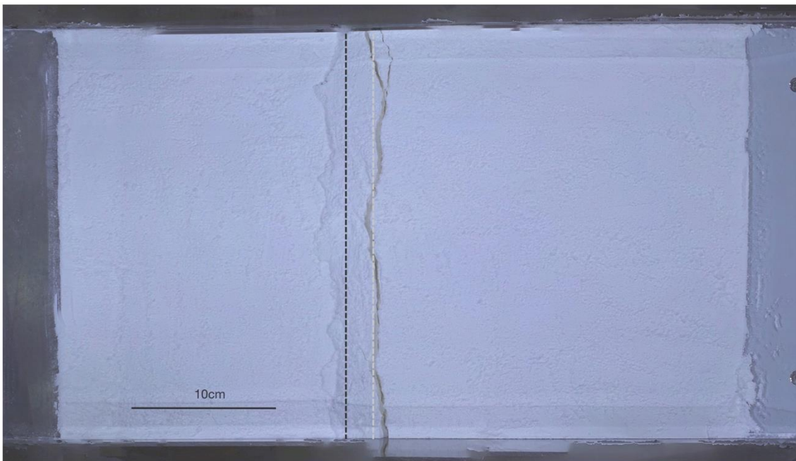
図 2-93 鉛直変位量 15mm のオルソ画像。灰色点線は模擬地盤底盤の断層ブロック境界、 黒色点線は断層の地表投影位置。
