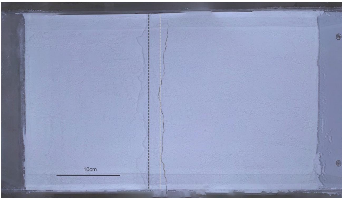
図 2-91 鉛直変位量 7mm のオルソ画像。灰色点線は模擬地盤底盤の断層ブロック境界、黒色点線は断層の地表投影位置。
