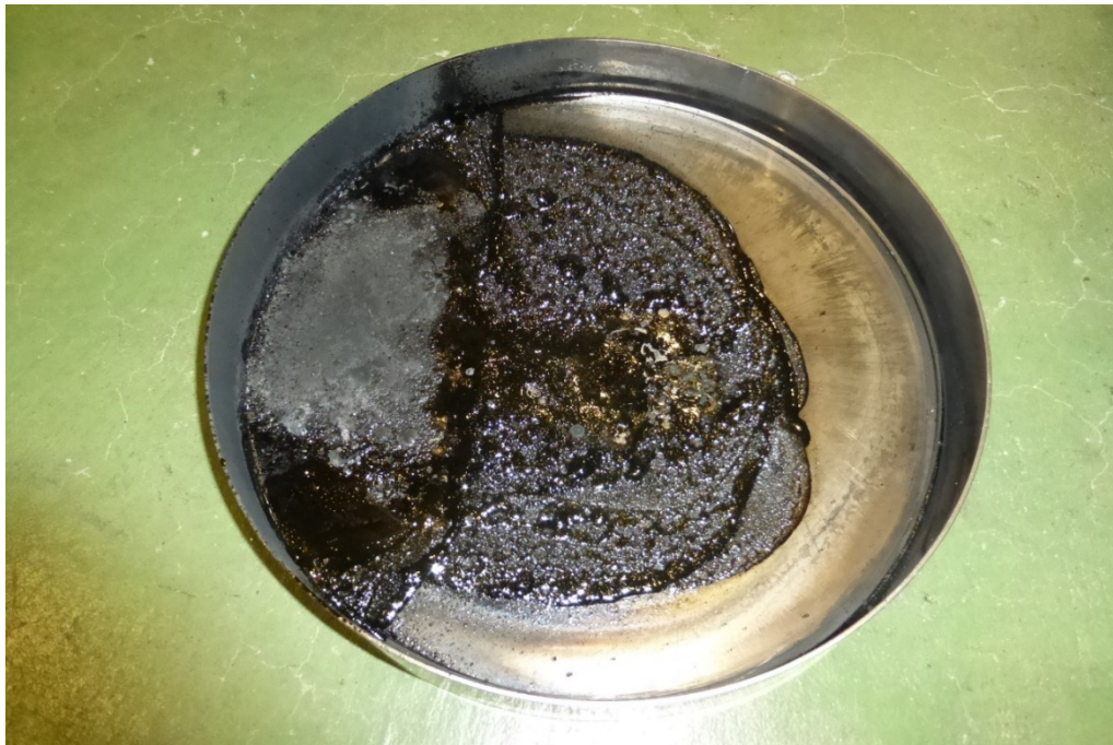
図 3.41 試験終了後の難燃 PMMA 試料残渣の様子 (EAF-13 試験)
