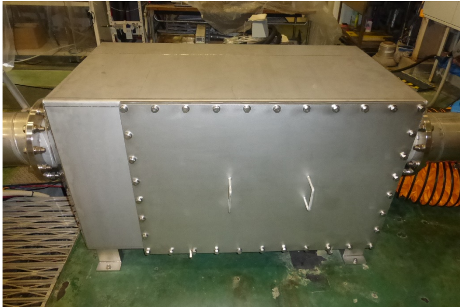
図 3.4 有機ガス吸収用フィルタハウジングの外観図
