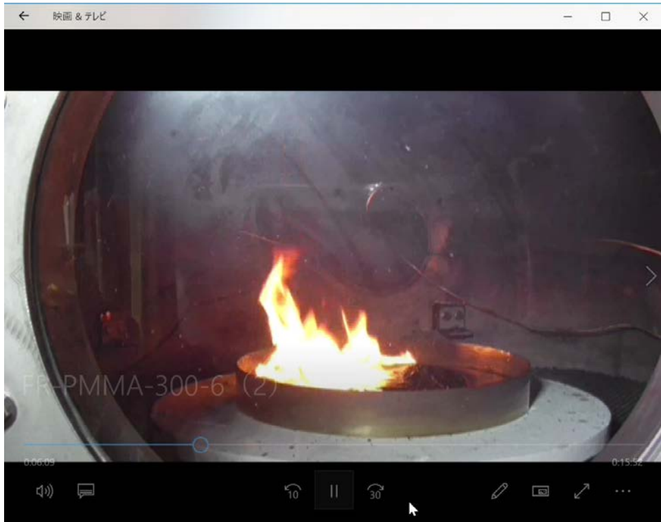
図 3.40 部分燃焼中の火炎の様子 (EAF-13 試験、着火開始から約 6 分後)
