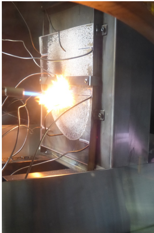
図 3.71 着火の様子 (DVP-5 試験)
