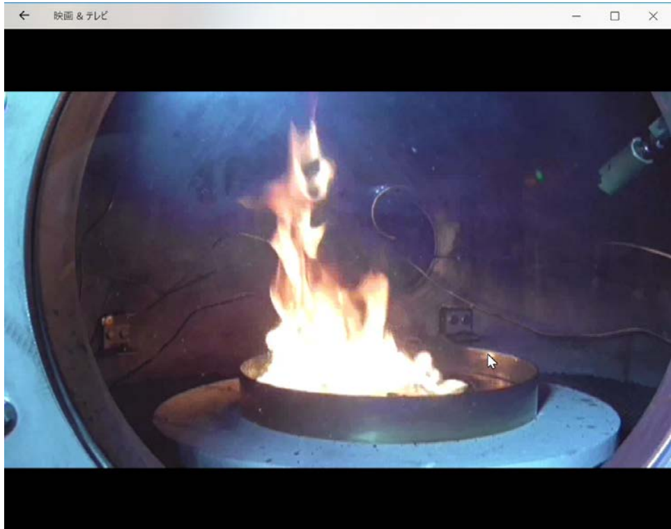
図 3.39 着火操作終了後の火炎の様子 (EAF-13 試験)
