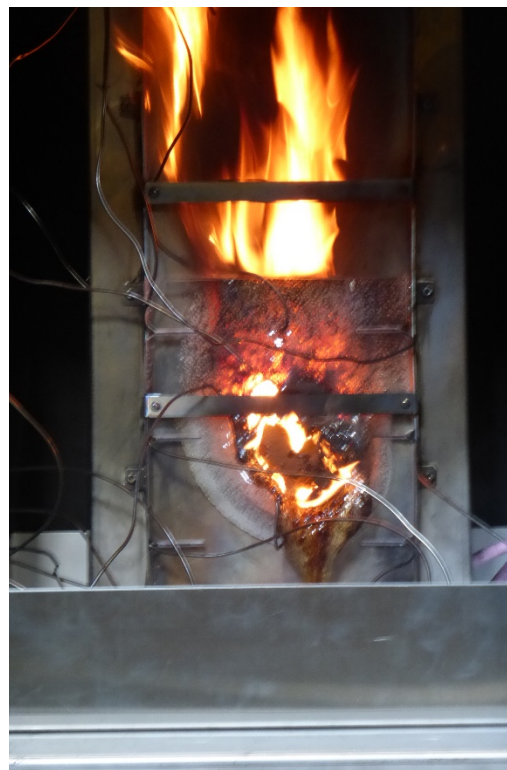
図 3.73 火炎の様子（DVP-5 試験、着火開始から約 2.2 分後）
