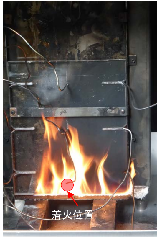
図 3.58 火炎の様子 (DVP-3 試験、着火開始から約 2.5 分後)
