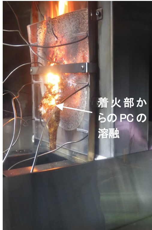
図 3.72 火炎の様子（DVP-5 試験、着火開始から約 1.7 分後）
