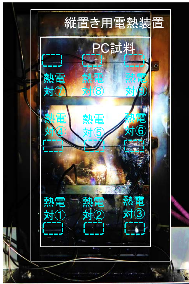
図 3.55 DVP 試験のセットアップの様子 (PC 試料を使用)
