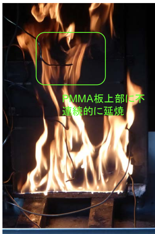
図 3.60 火炎の様子（DVP-3 試験、着火開始から約 4.5 分後）
