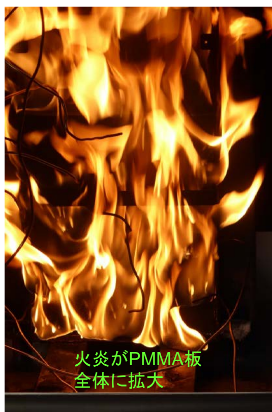
図 3.61 火炎の様子（DVP-3 試験、着火開始から約 7.6 分後）
