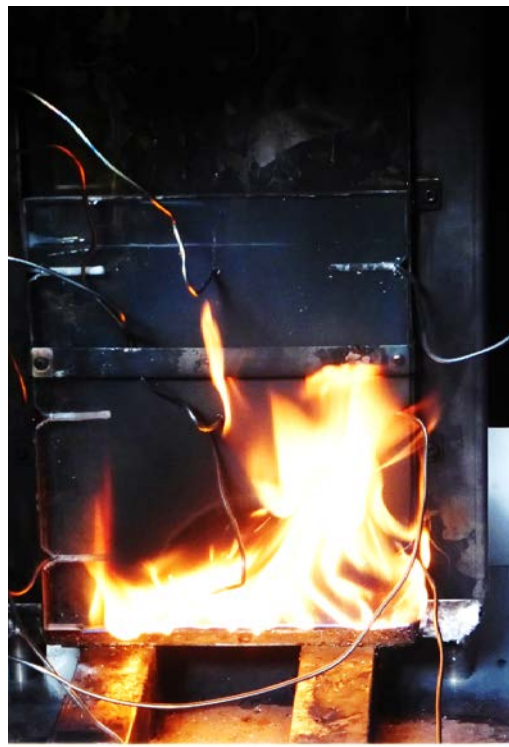
図 3.59 火炎の様子 (DVP-3 試験、着火開始から約 3.5 分後)
