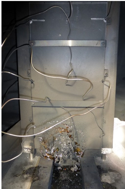
図 3.85 自然鎮火後の PC の様子 (DVP-8 試験)
