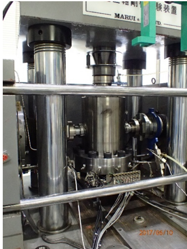
図 2.2.1-9 大型真三軸試験装置（圧力容器設置時）。
