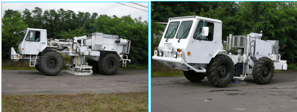
図 2.1.1-1 大型バイブロサイズ（左）および中型バイブロサイズとその緒元
