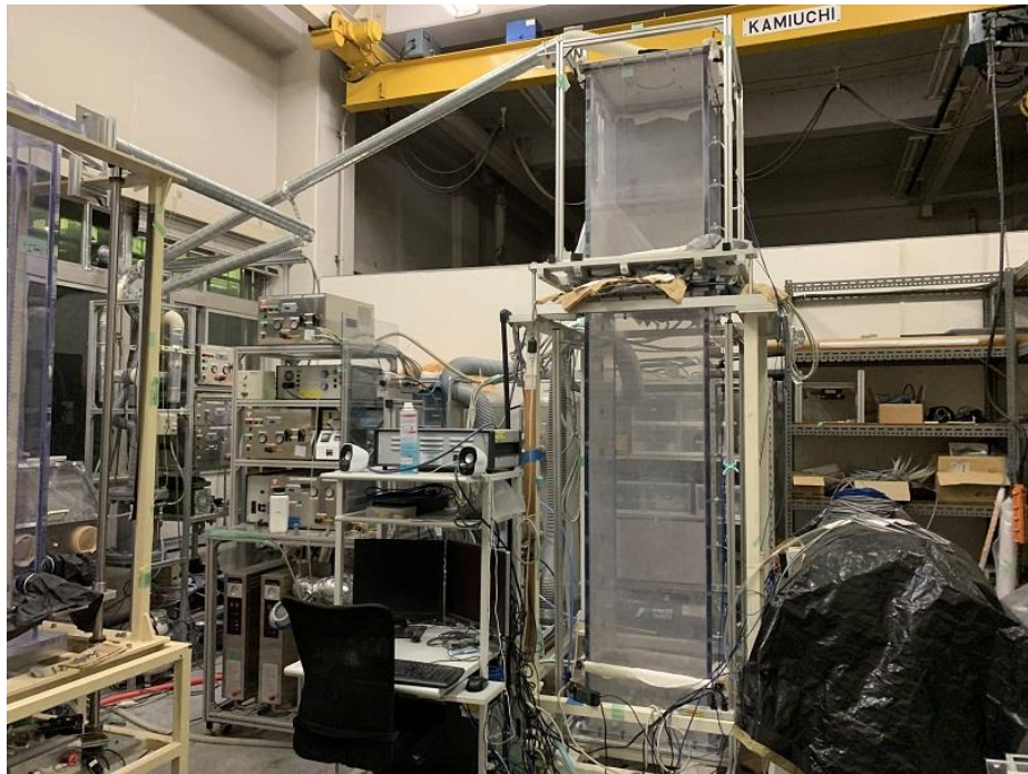
図 5-1 二相流実験装置外観
