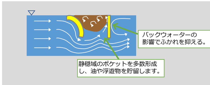
図 3.1 2 枚のフェンスを用いた油状物質等の滞留。http://www.nihonsolid.co.jp/14-oilfen02.html を基に複製（一部修正）
