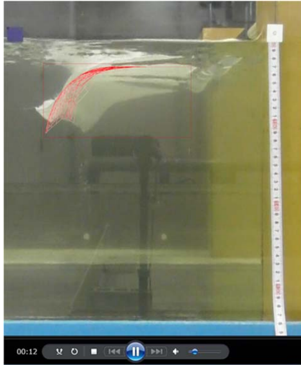
図 6-14 シミュレーション結果と水槽実験結果の比較 (鉛直方向フェンス形状 : X-Z 射影)
