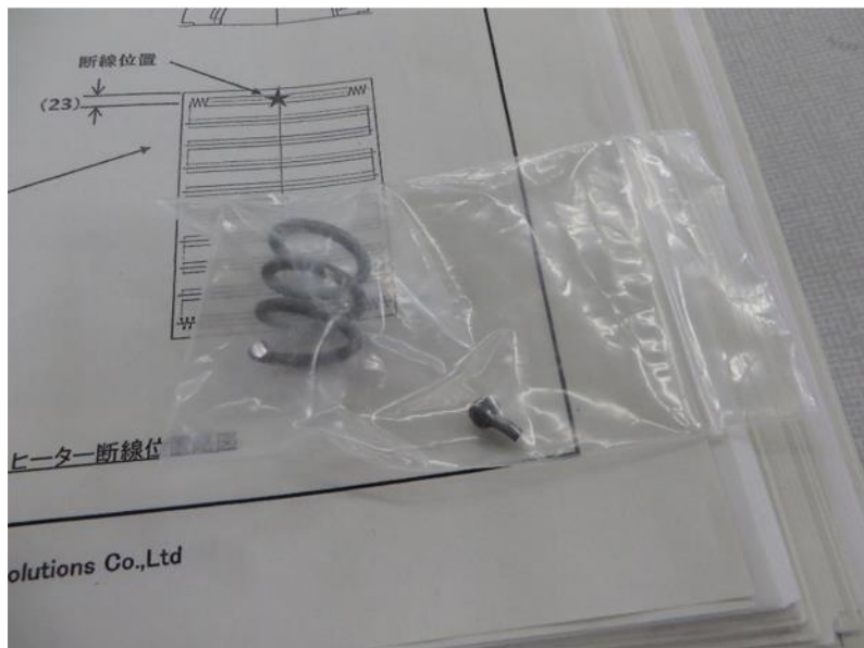
図 4.7-3 溶断したヒーター線の一部
