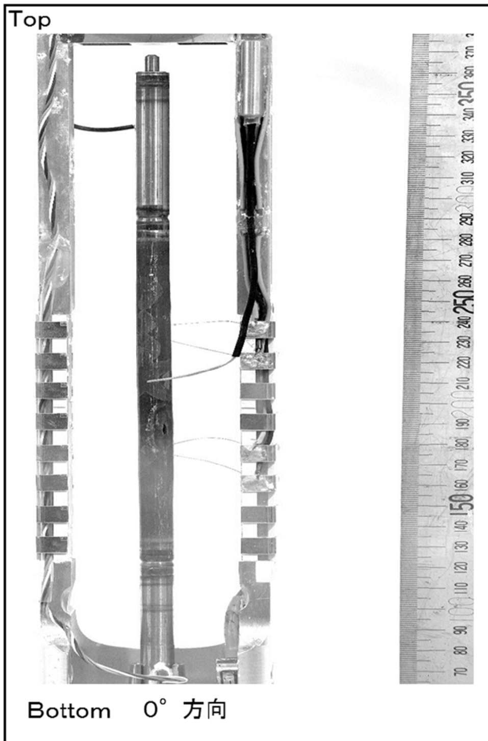
図 4.3.1-8 (1) CN-1 試験燃料棒のパルス照射後外観写真 (0° 方向)
