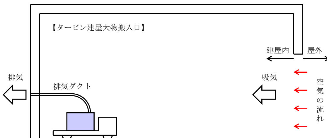
第1図 5号炉原子炉建屋内緊急時対策所用可搬型電源設備及び排気ダクトの敷設図
