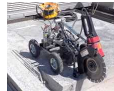
溝切ロボット(モックアップ機)
