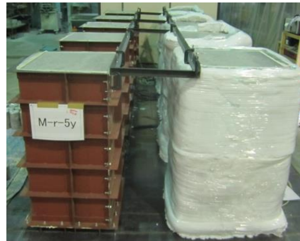
(左：非加熱／右：加熱) 写真-1 加熱試験状況
