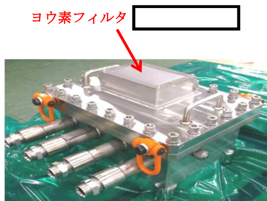
図9 ヨウ素フィルタ付き検出器写真
