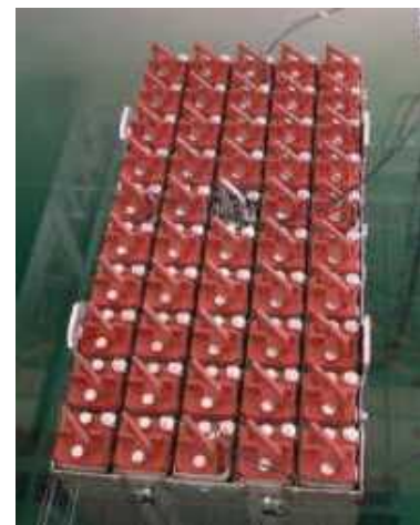
(2) 供試体の水槽内設置状態
