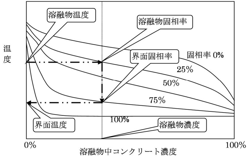
図3 溶融燃料とコンクリート成分の状態図の例
