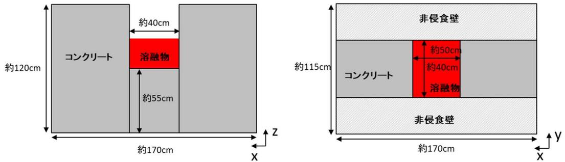
図5 CCI-4 実験解析の幾何形状の例
