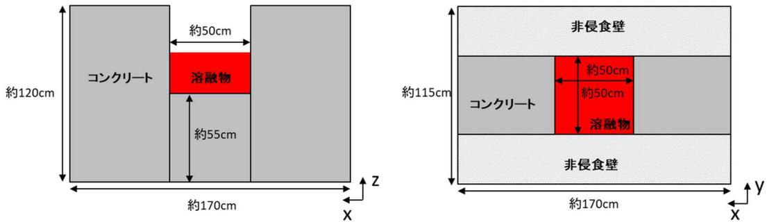
図4 CCI-2 実験解析の幾何形状の例
