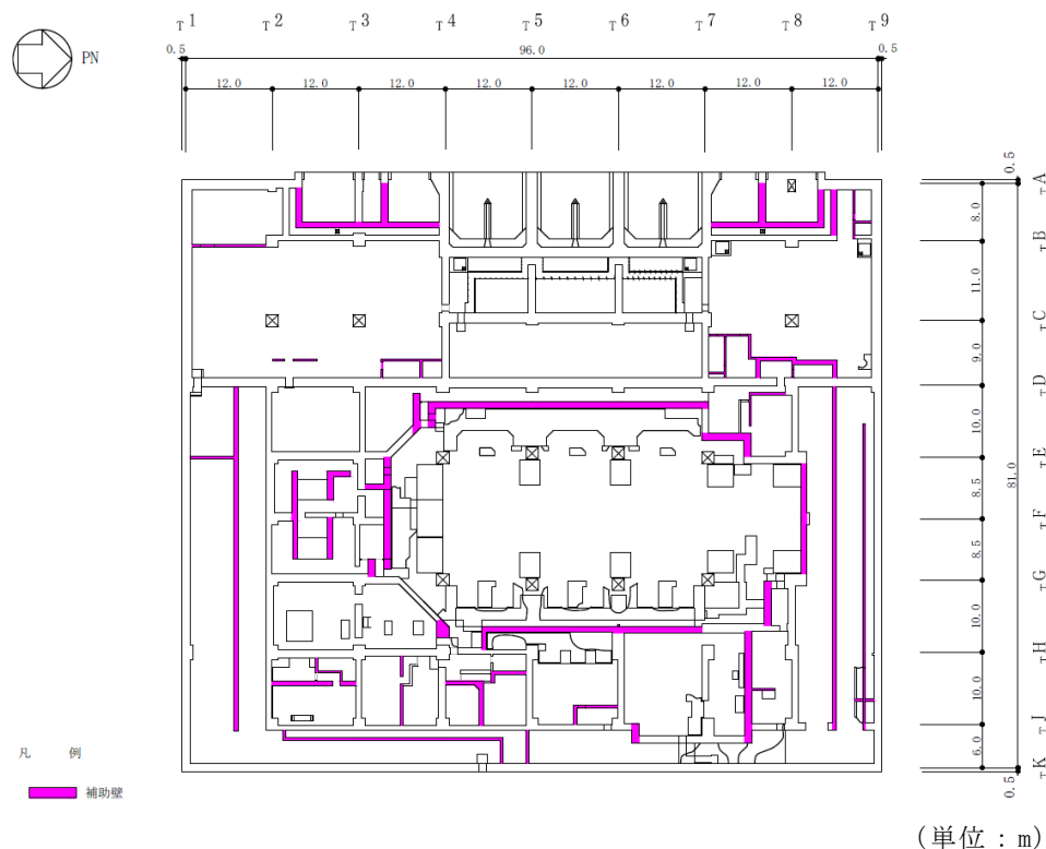
図2-1 補助壁の考慮範囲（B2F，T.M.S.L. -5.1m）
