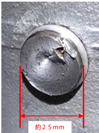
折損断面（駆動部側）
