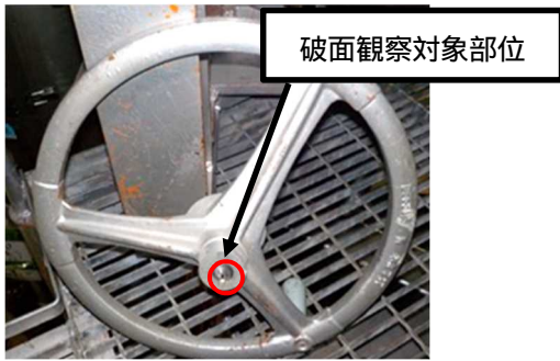
折損した手動操作ハンドル
