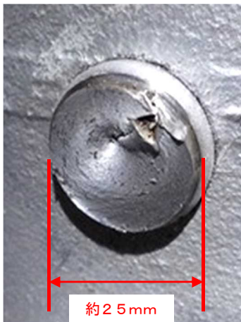
折損断面（駆動部側）
