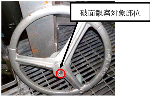
折損した手動操作ハンドル
