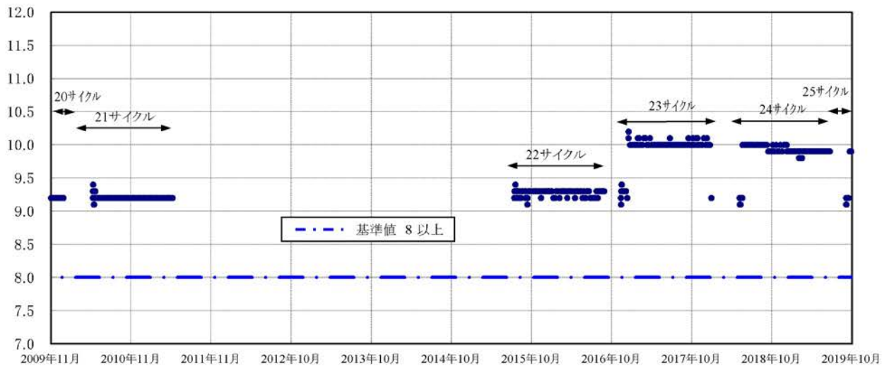
蒸気発生器器内水 pH
