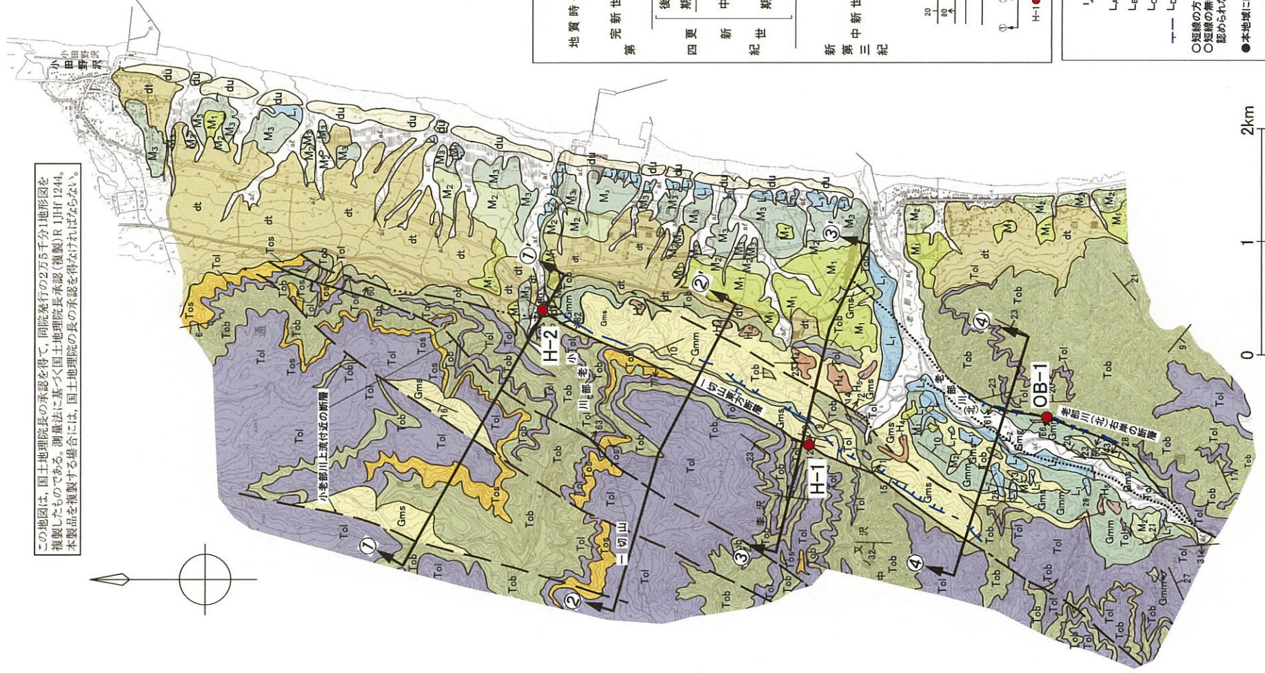
第3.2-57図 一切山東方断層及び小老部川上流付近の断層周辺の地質平面図
