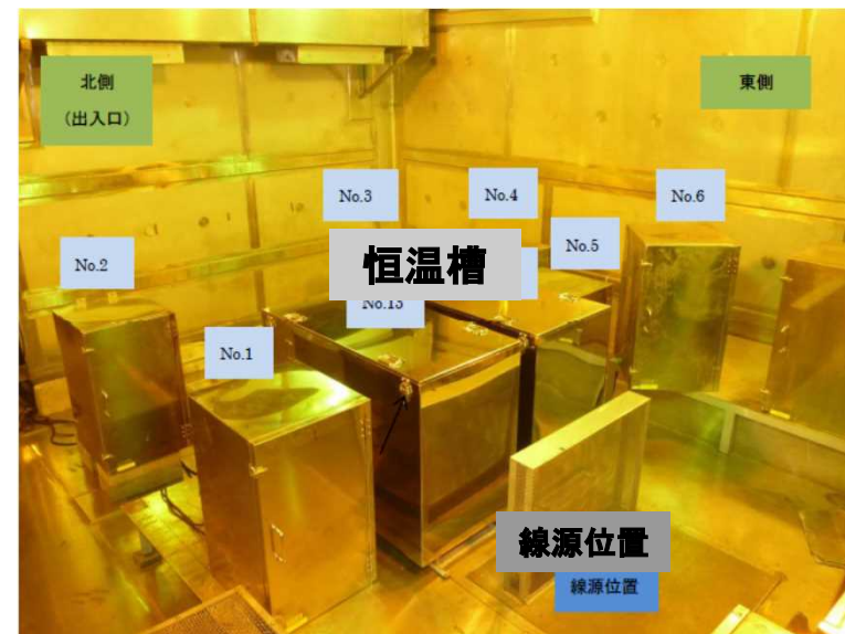
図3 照射施設内に設置した劣化処理用恒温槽
