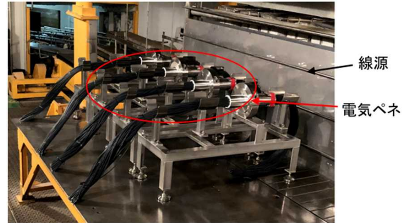
図4 電気ペネトレーションに対する事故時照射
