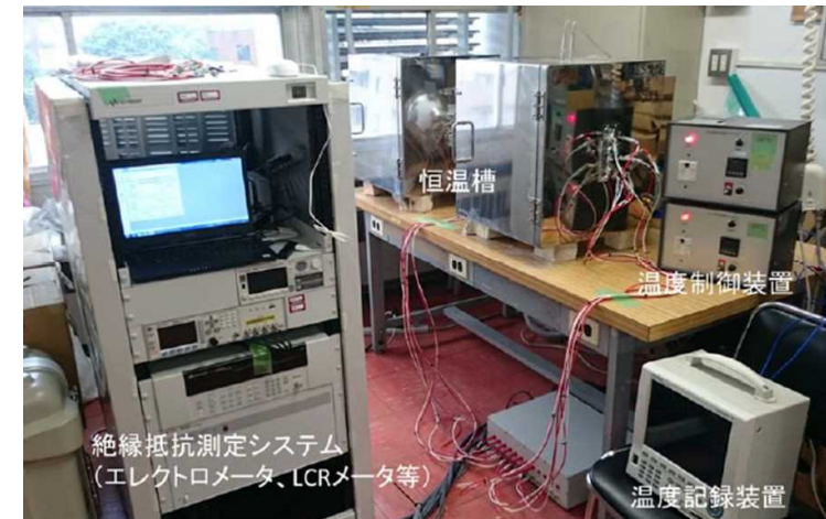
図10 ケーブル大気中加熱試験の装置
