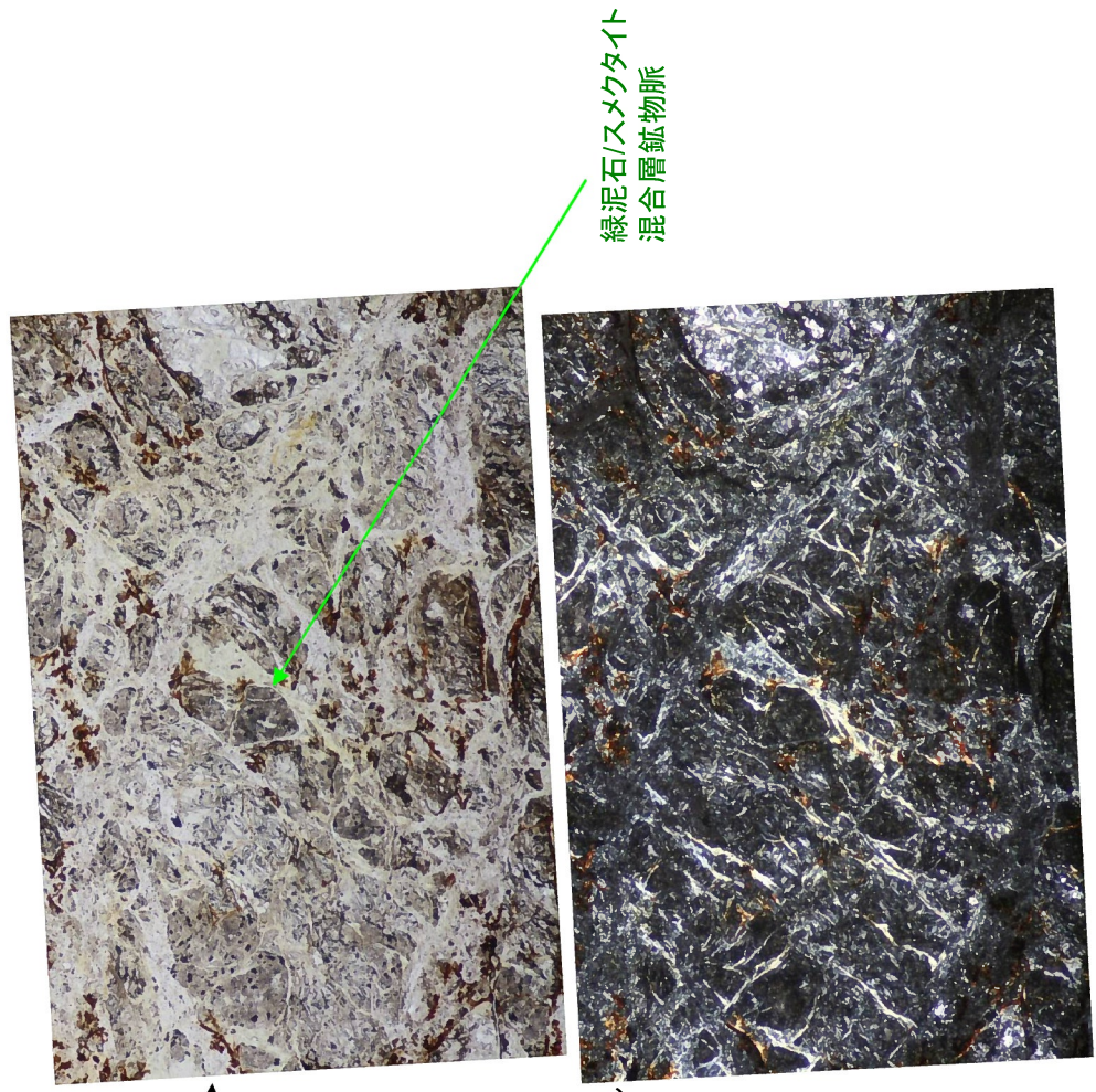
第1.2.3.4.18図(4) 山頂トレンチF-6 破碎帯 薄片観察結果 (その3)
