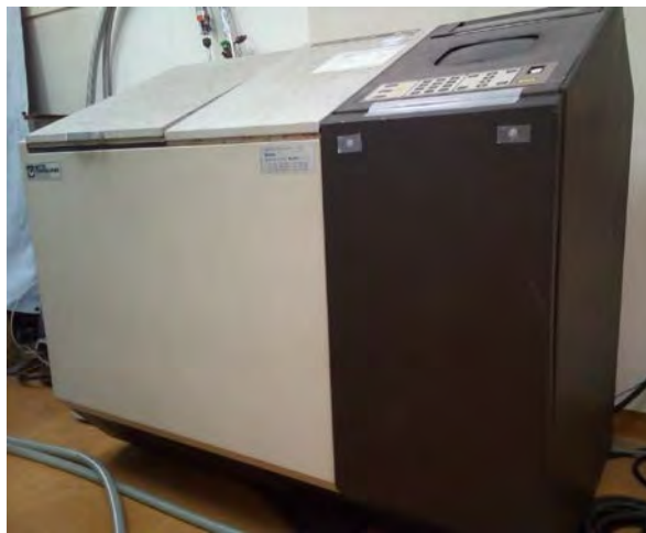
図2 液体シンチレーションカウンタ外観写真
