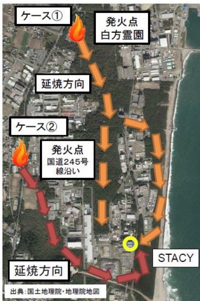
図4-2 発火点及び延焼の考え方
