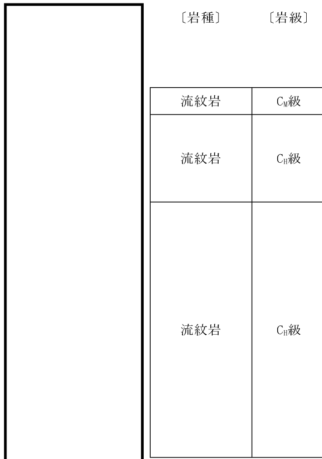
第 2-2 図 1次元応答解析用地盤モデル
