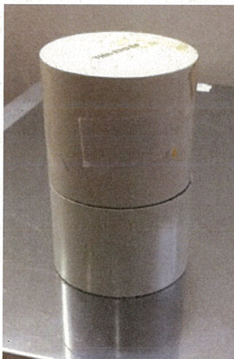
図2. 表示付認証機器を保管していた鉛容器
