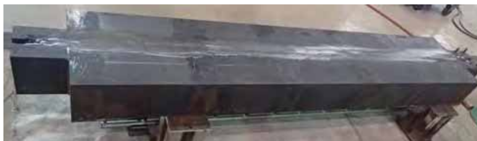
図 3.1.1.1-6 継手溶接後の外観写真
