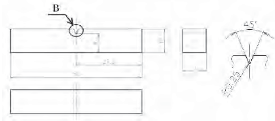
シャルピー衝撃試験用試験片
