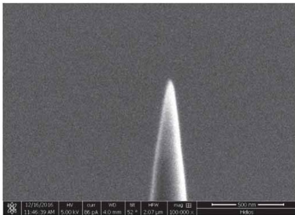
図 3.2.2.2-1 FIB によって作製した APT 分析用試験片
