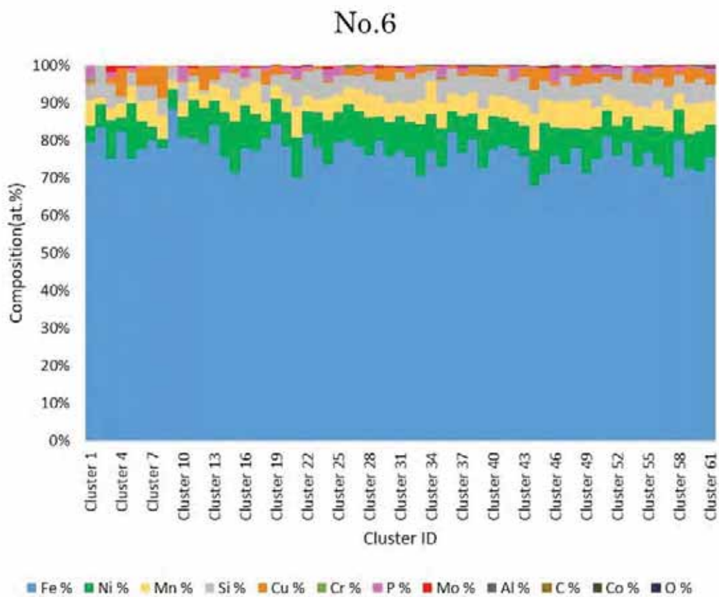
図 3.2.2.2-23 サンプル No.6 の溶質原子クラスタ化学組成
