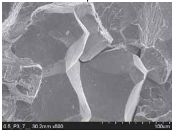
図 3.1.1.2-41 SEMによる0.5TCT試験片の破面観察結果 (P3材SC、符号:0.5TCT-P3-7、 K_{Ic}=63.4 \text{ MPa}\sqrt{\text{m}} )
