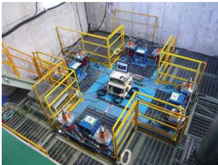
(2)ジャッキシステム、反力フレーム、ダミー試験体のピット内支持構造に設置した状況
