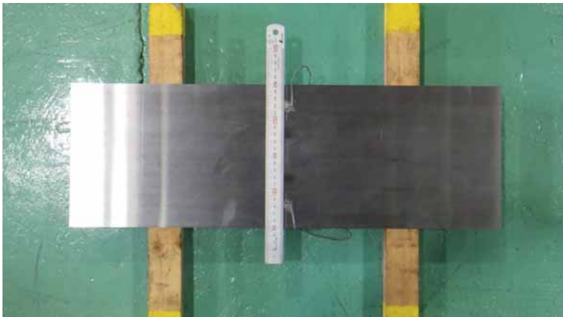
図 3.1.2.3-15 ひずみゲージの位置(JSW-4A-K-2-U)
