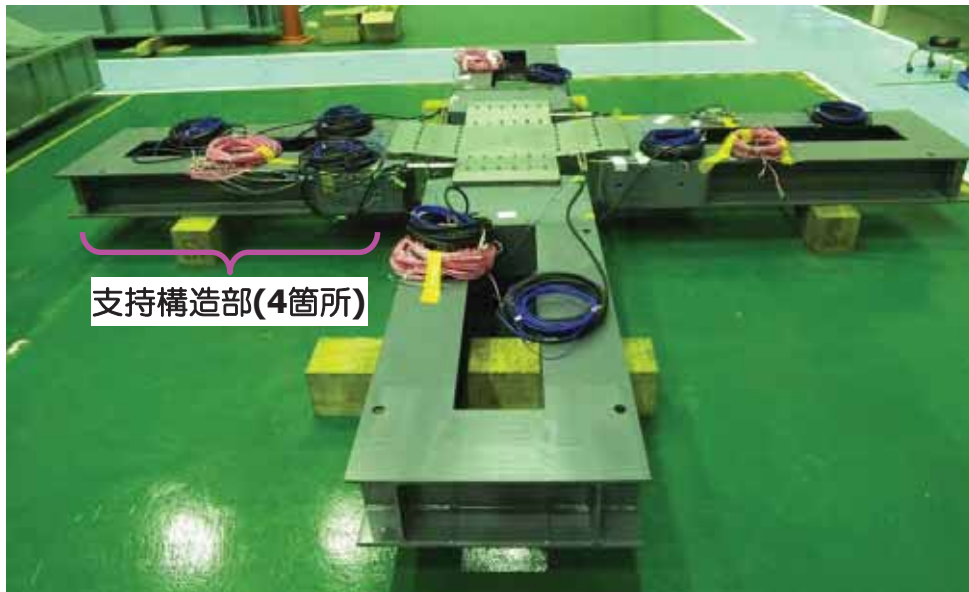
図 3.1.3.3-16 加熱・冷却検証試験体と支持構造部連結状況
