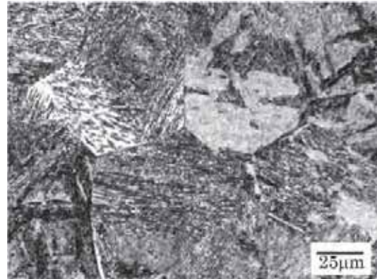
(3)C2 材(980℃焼入れ、480℃×4 時間焼戻し、ビッカース硬さ 356HV)
