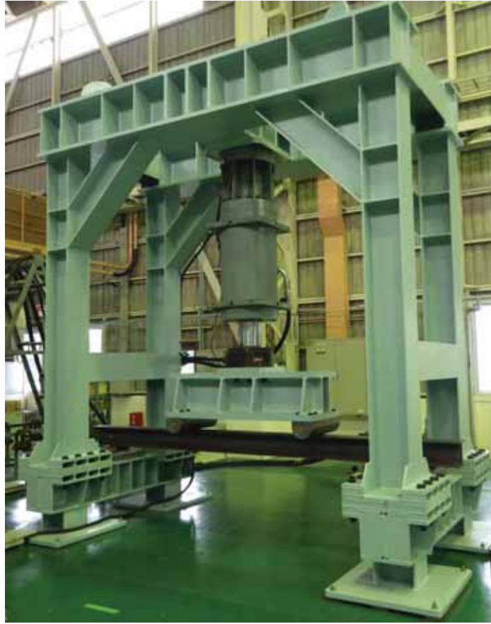
図 3.1.3.1-45 疲労亀裂導入設備
