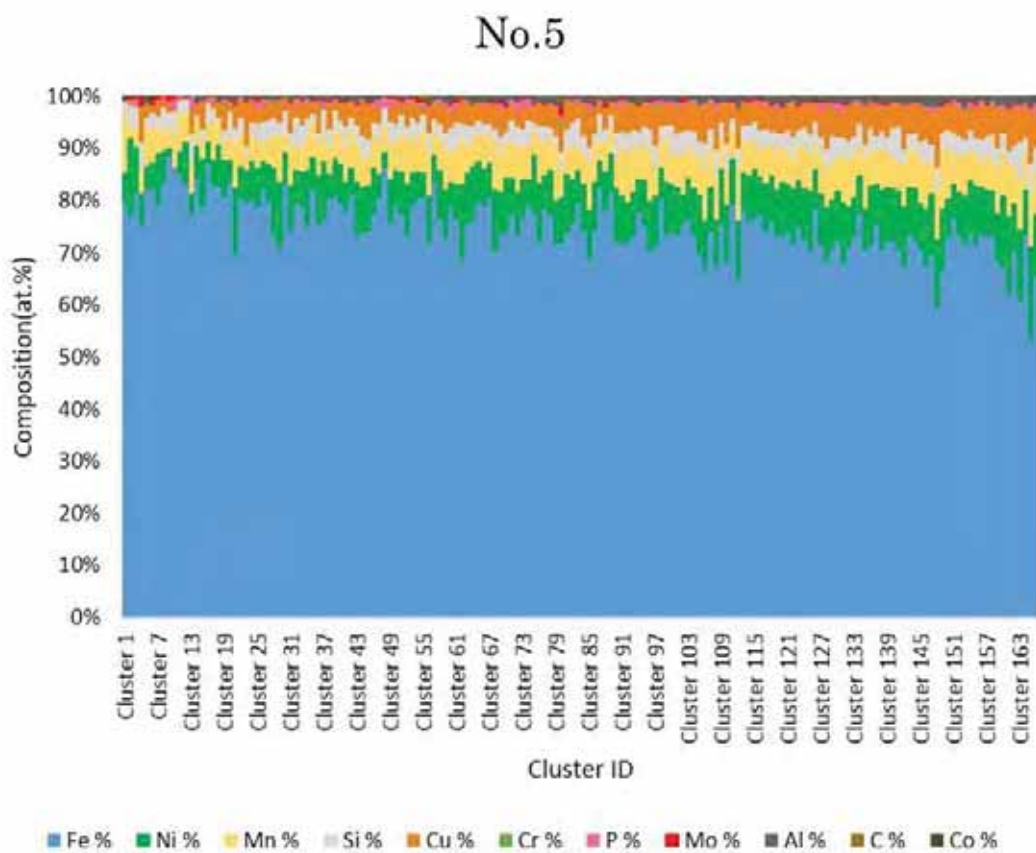
図 3.2.2.2-20 サンプル No.5 の溶質原子クラスタ化学組成
