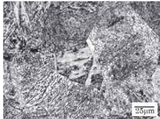
(2)B1 材(980°C焼入れ、480°C×4 時間焼戻し、ビッカース硬さ 328HV)
