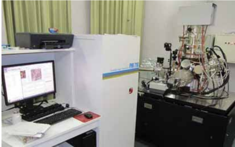
図 3.2.2.3-2 AES 分析装置 PHI710 外観
