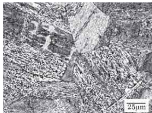
(3)B4 材(980°C焼入れ、480°C×4 時間焼戻し、ビッカース硬さ 325HV)
