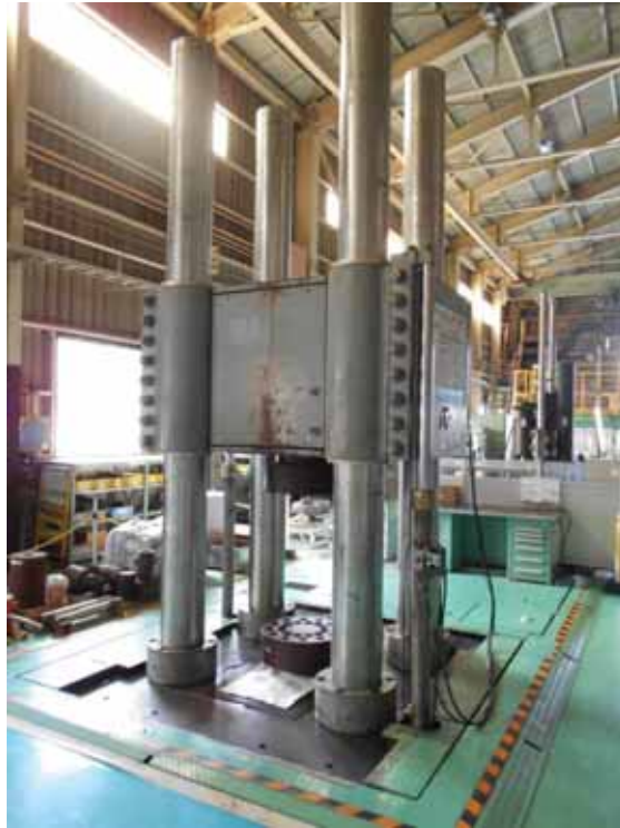
図 3.1.2.3-2 ±10MN 電気油圧式サーボ疲労試験装置(MTS 社製)
