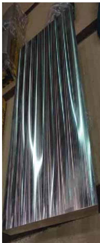
図 3.1.1.1-1 初期プラント模擬材用母材の外観写真 (長さ(L)約 2,500 mm、幅(W)約 1,000 mm、厚さ(t)が約 200 mm)
