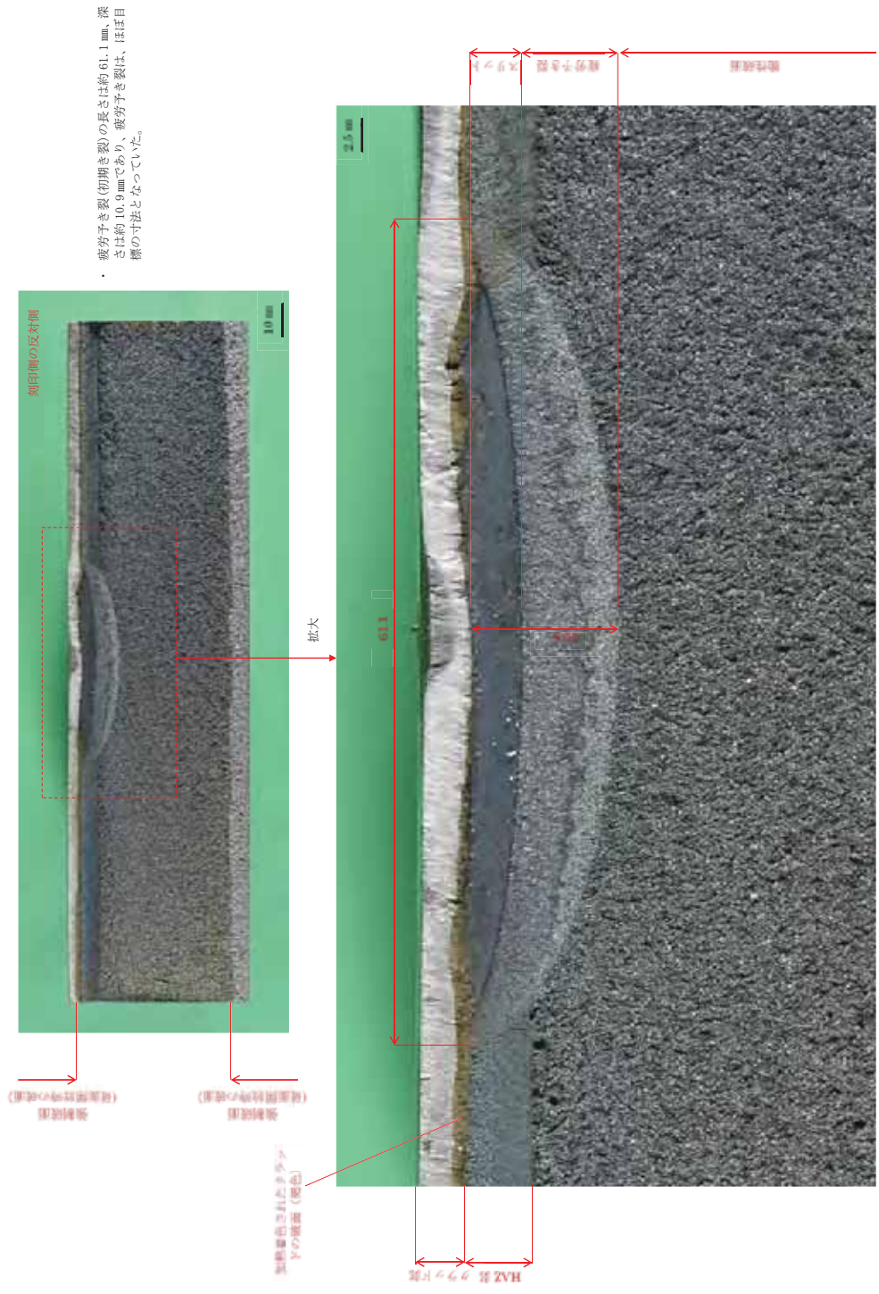
図 3.1.2.3-34 試験後の試験体の破面外観状況 (クラッド: サブマージドアーク溶接, 熱処理: 510°C×4h, 試験体刻印番号: JSW-4A-K-1-U, 試験温度: 室温)
