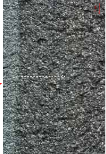
図 3.1.2.3-97 試験後の試験体の破面外観状況 (クラッド：サブマージドアーク溶接，熱処理：510°C×4h，R付与加工有，試験体刻印番号：JSW-4A-K-1-L，試験温度：室温)
