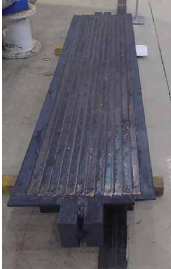
図 3.1.1.1-8 クラッド溶接施工後の初期プラント模擬材(溶接継手)の外観写真
