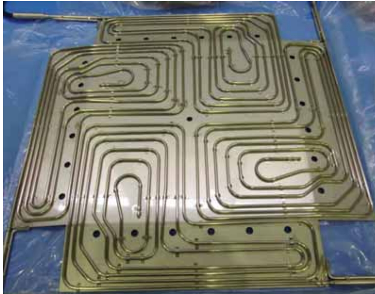
図 3.1.3.1-40 供試体加熱ヒータ
