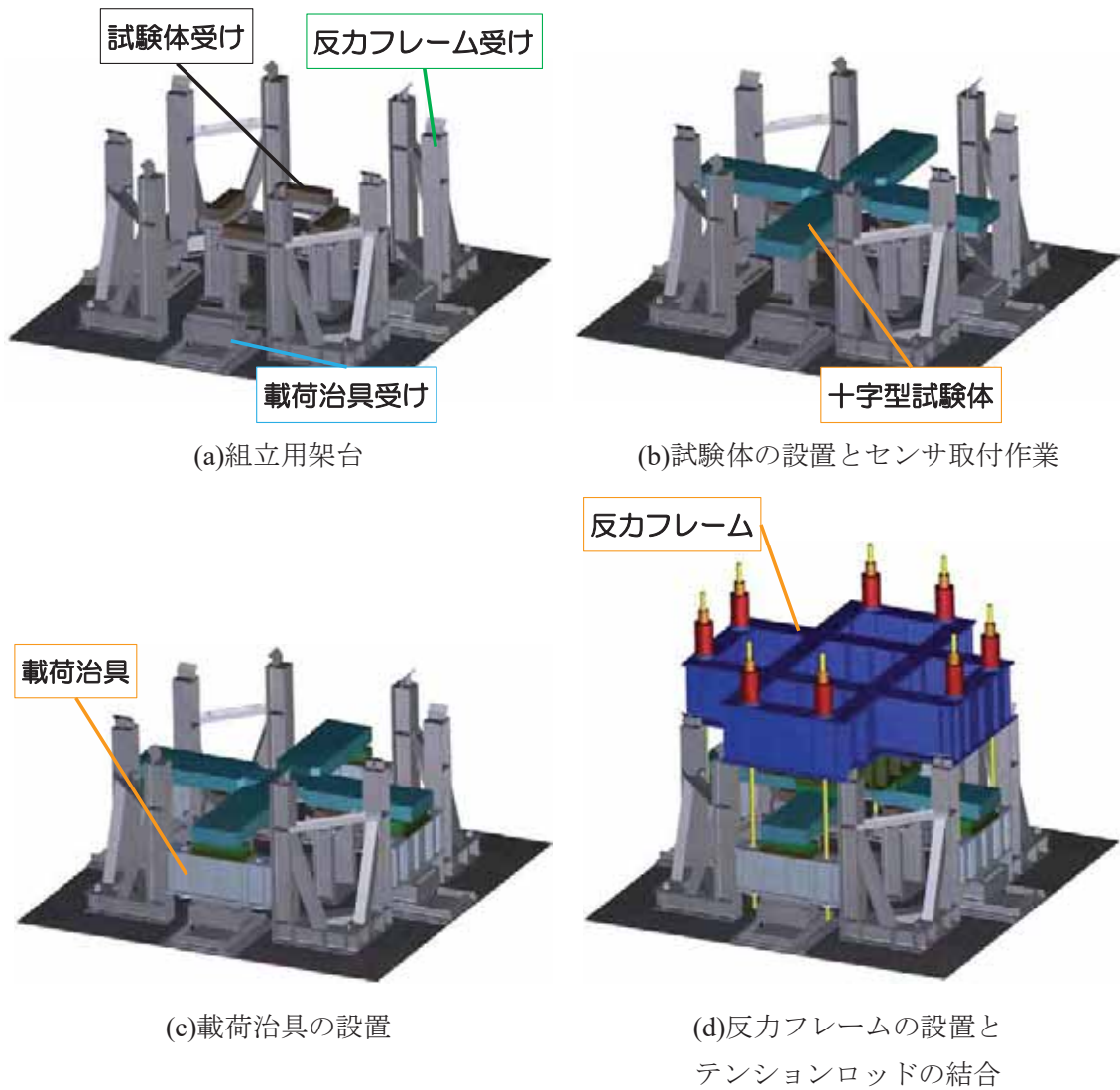
図 3.1.3.1-31 PTS 模擬試験準備時の十字型試験体等の組立手順
