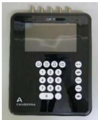
写真 3.1.2-1 試験に使用した JSR-15 (Canberra Model: JSR-15 S/N: 13000030)
