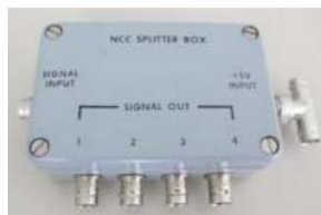
写真 3.1.2-2 試験に使用した信号分岐装置（LANL 製）
