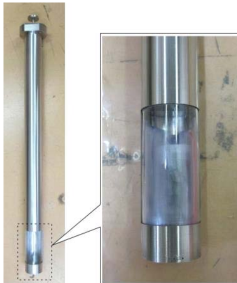
写真 3.1.2-4 サンプルホルダー（拡大：サンプル収納部）
