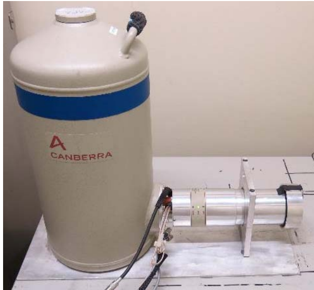
写真 3.2.2-1 JAEA 所掌の HRGS (検出器) (Canberra Model: GL0515R S/N: 04034924)
