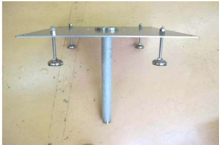
写真 3.1.2-3 J-MOX における AVIS 設置予定のグローブボックス底部を模擬した治具
