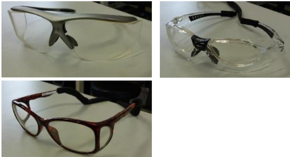
図 5-8 方向別水晶体線量遮蔽能力に使用した防護メガネ
