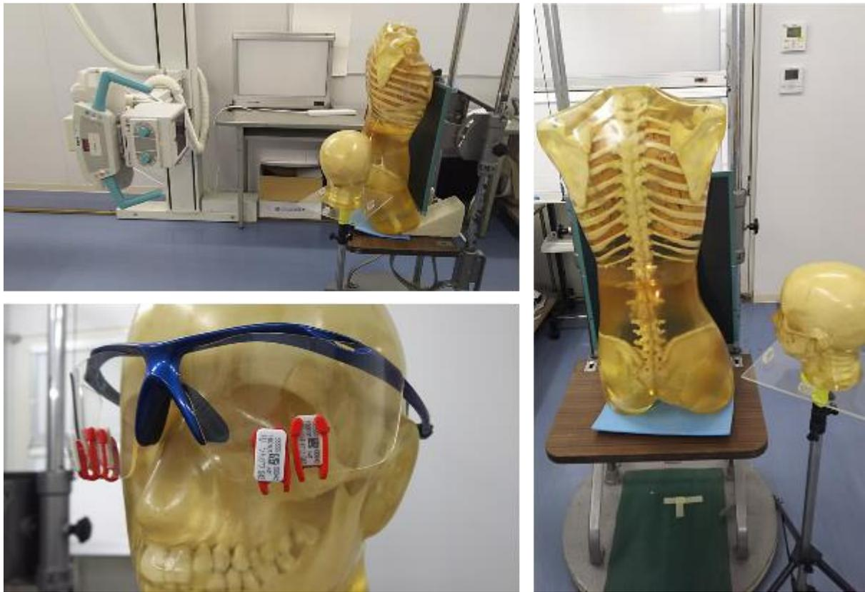
図 5-7 腹部撮影介助時の医療従事者の水晶体線量評価の配置図
