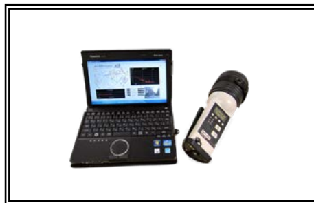
ラジプローブシステム (走行しながら空間線量率の測定・記録・通信が可能)
