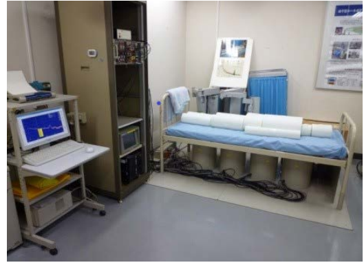
ホールボディカウンター (校正用 BOMAB ファントム)
