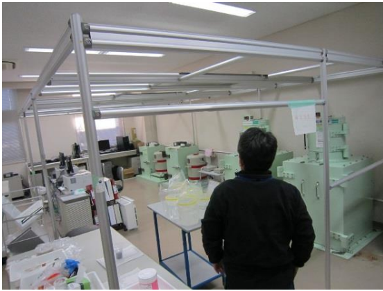
放射能測定室（ゲルマニウム半導体検出器の周囲をクリーンブースで囲っている）
