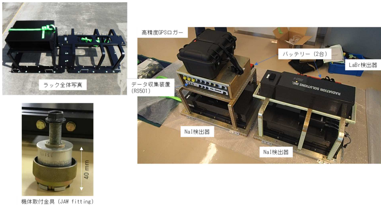
Fig. 5-1 製作したラックの写真
