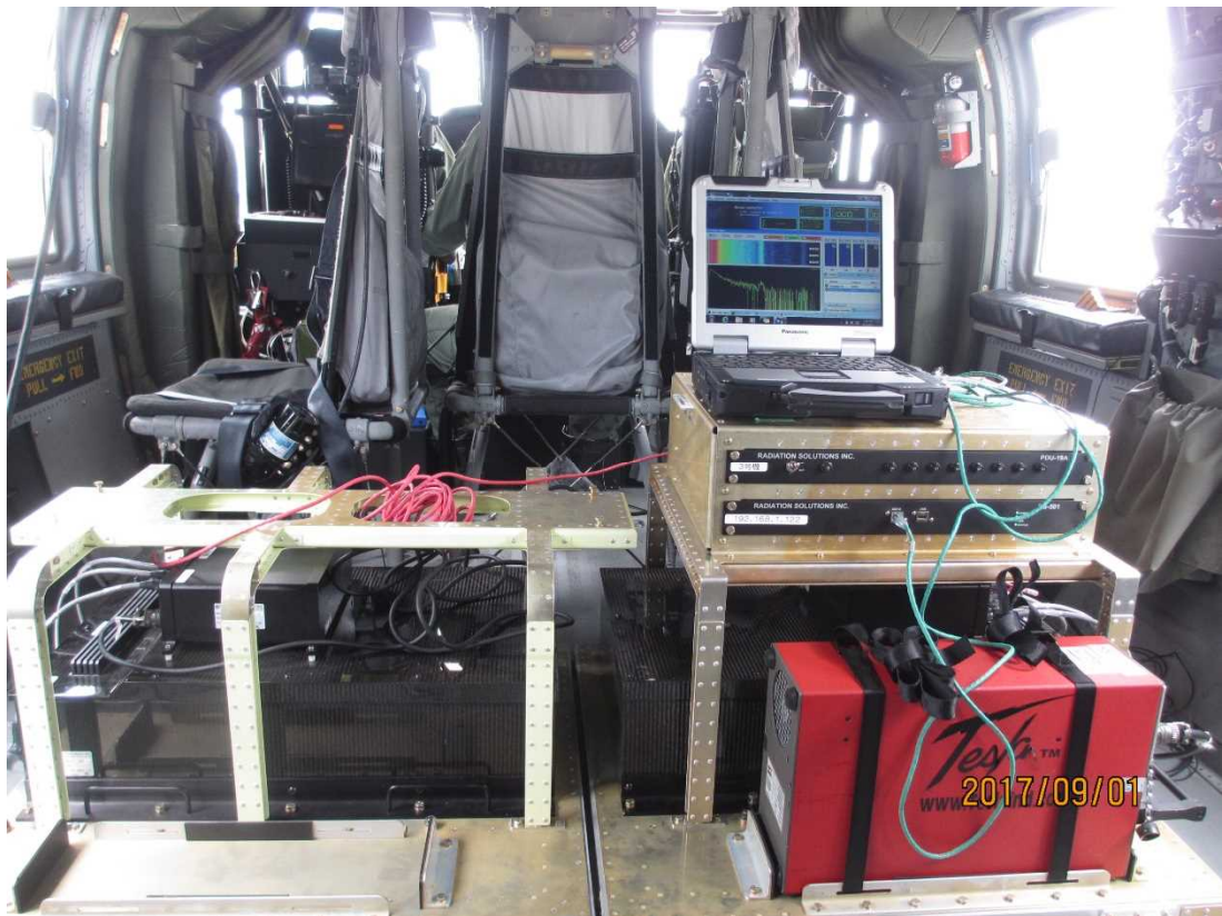
図 2 航空機モニタリング機材搭載状況
