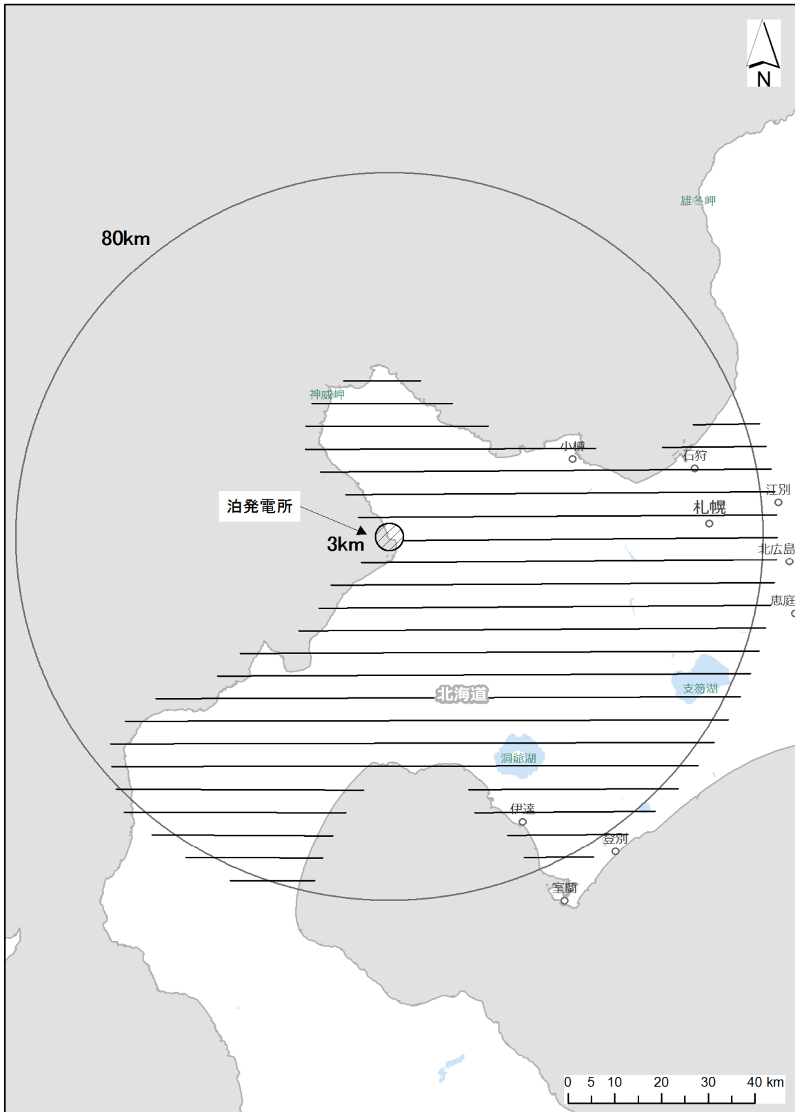
Fig. 3-1 予定したフライトの測線(泊) (背景地図は、ArcGIS データコレクションスタンダードパック (ESRI, Co. Ltd.) を使用)
