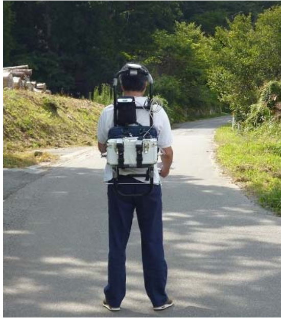
図-2 歩行サーベイ測定時の装備
