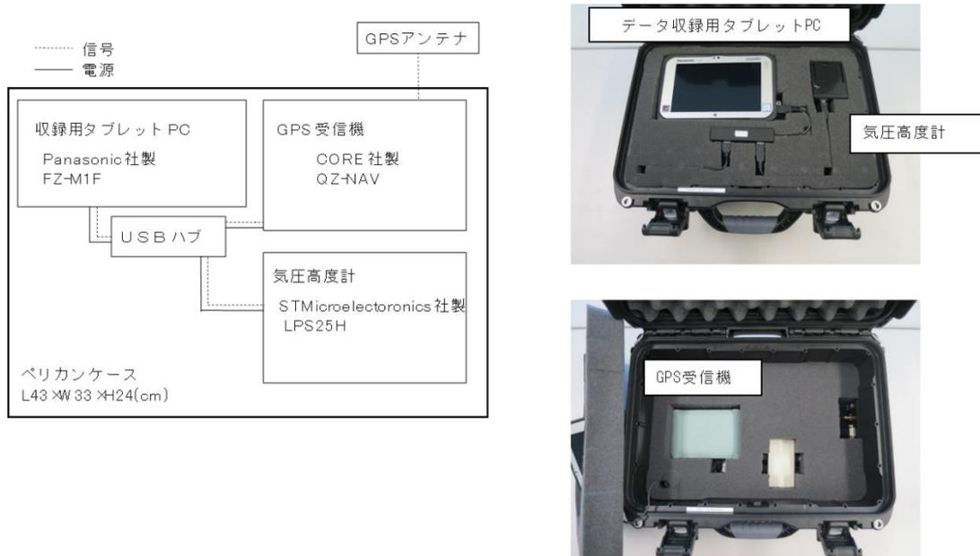
Fig. 8-1 GPS の接続図と外観
