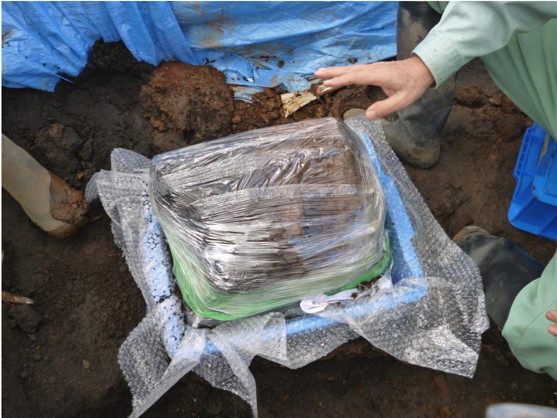
図 2-78 ブロックサンプリング採取状況：西側壁面
