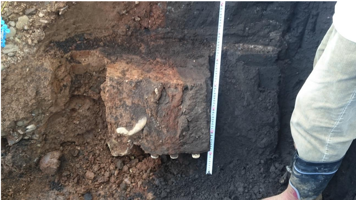
図 2-75 ブロックサンプリング採取状況：西側壁面
