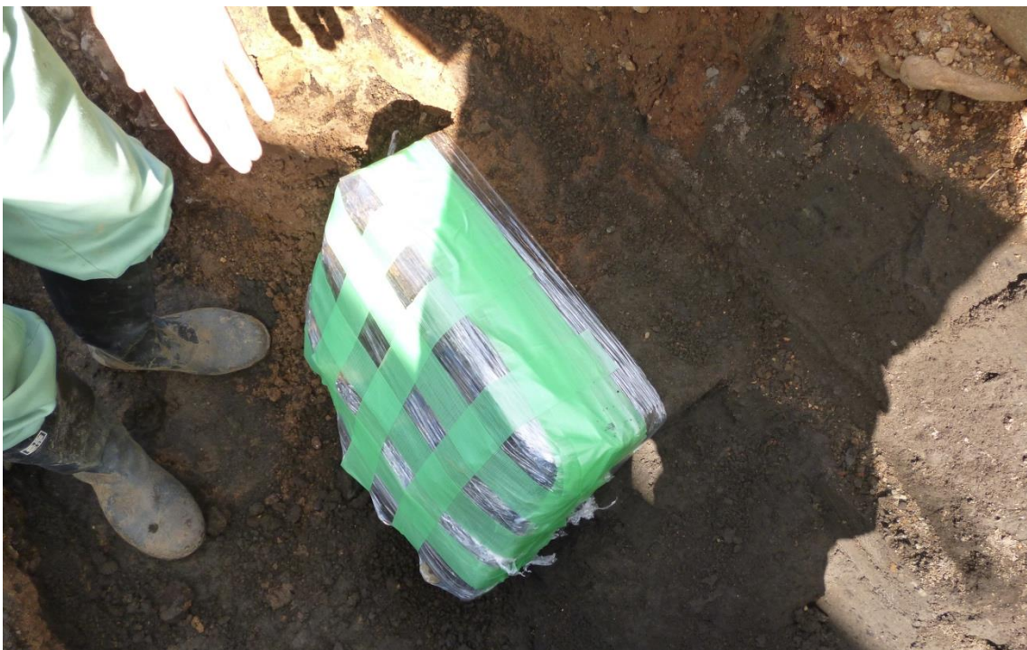
図 2-77 ブロックサンプリング採取状況：西側壁面
