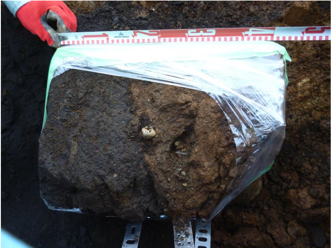
図 2-73 ブロックサンプリング採取状況：東側壁面
