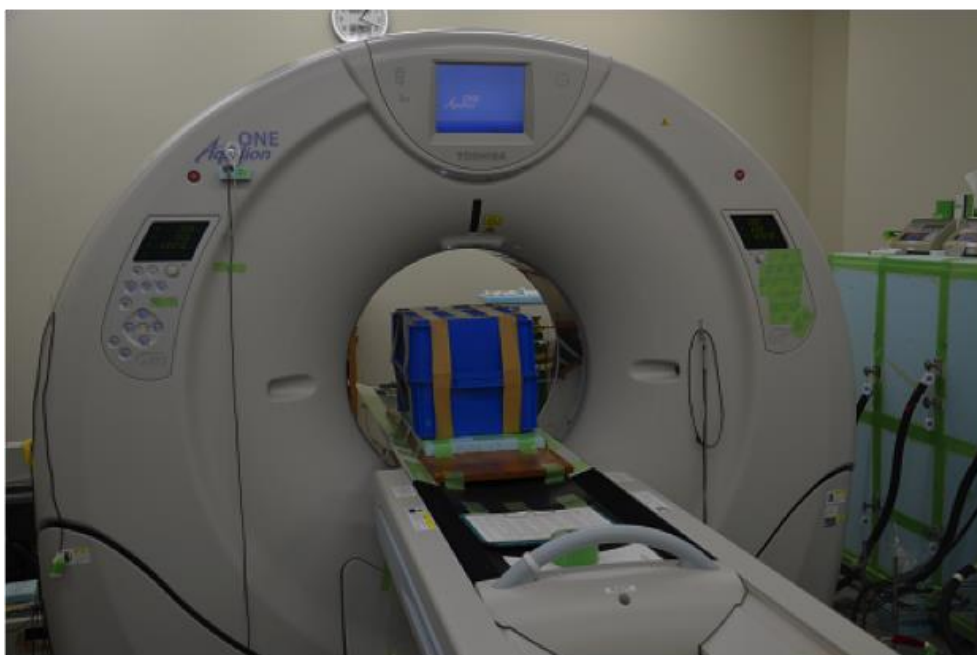
図 2-79 ブロックサンプリング X 線 CT 撮影状況。写真の奥側に向かって頭側 (H) になる。仰向けで寝た状態で、右手側が R になる。
