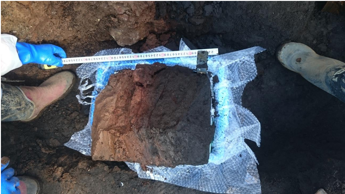
図 2-76 ブロックサンプリング採取状況：西側壁面
