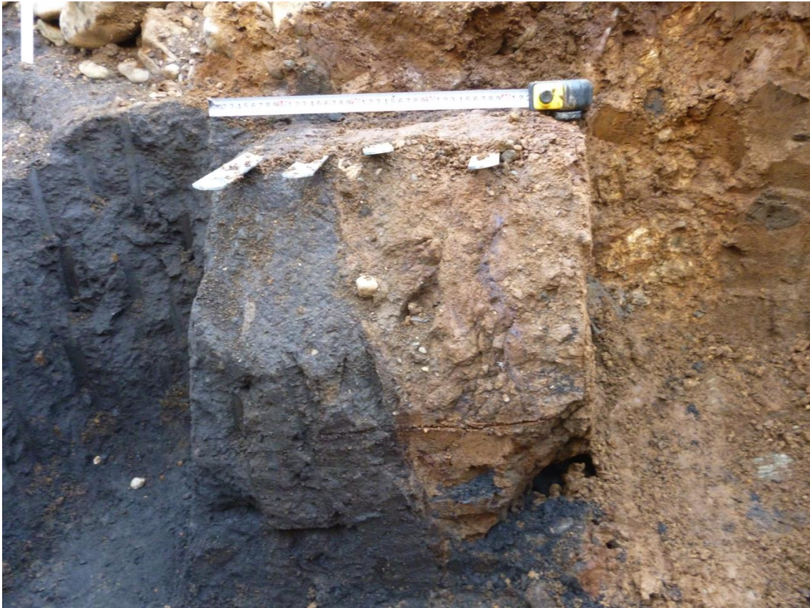
図 2-72 ブロックサンプリング採取状況：東側壁面
