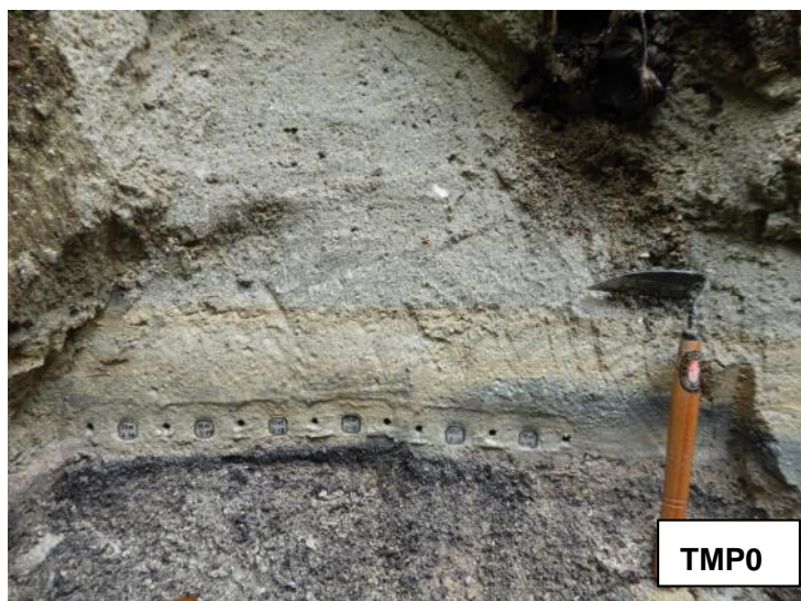
図10. 十勝三股火砕流の古地磁気サンプル写真。下位からTMP0～TMP2。
