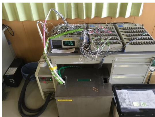
図 5.4. ASR法応力測定システムの模式図（上図、Sugimoto, 2018）と本研究に用いた京都大学所有のASR測定システムの写真（下図）
