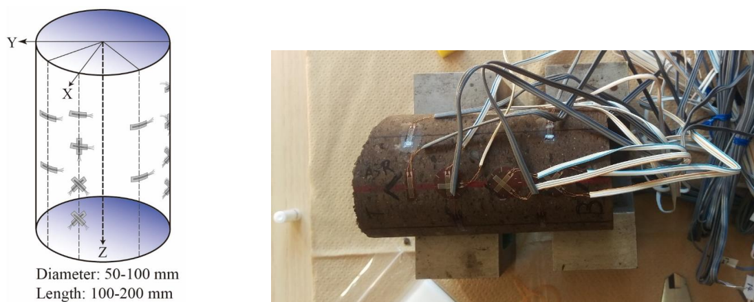
図 5.12. (a) ASR 測定用掘削コア試料に張りつけるひずみゲージのレイアウトと、(b) ボーリング孔 FDP-2 の測定に用いられたコア試料（試料番号 FDP2-ASR01）の写真
