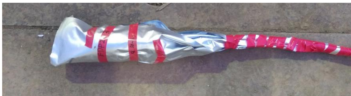
図 5.3. ASR 測定用掘削コア試料を密封するために、ビニール袋（2重）とアルミの袋に閉じ込めた状態の写真
