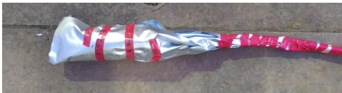
図 5.13 ASR 測定用掘削コア試料を密封するために、ビニール袋（2重）とアルミの袋に閉じ込めた状態の写真
