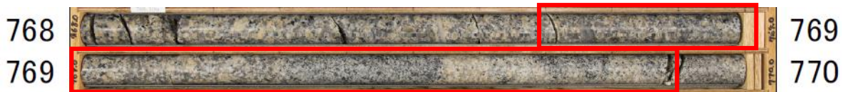
図 4.1.2-3 AFD-1-W1 孔 水圧破碎試験区間候補③ (768.73 – 769.88 m)
