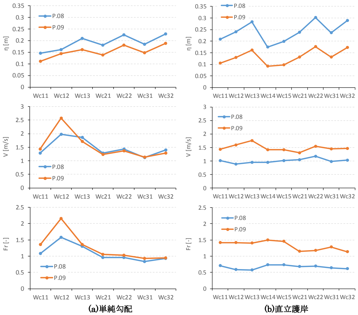
図-7.1.1 防潮堤設置位置における最大浸水深と流速，フルード数
