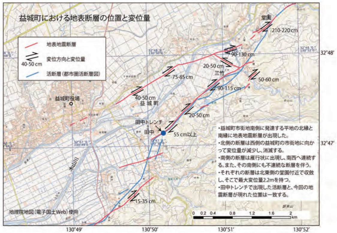
図 3.2.2(1)-22 益城町における地表地震断層の位置と変位量 (産業総合技術研究所, 2016)
