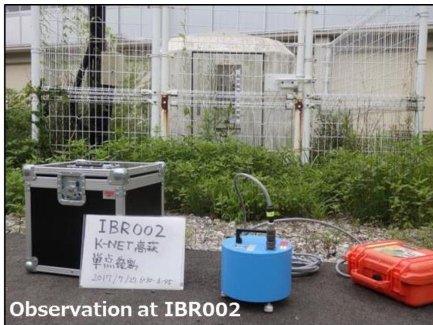
図 3.1.1(1)-8 単点微動観測システムの写真
