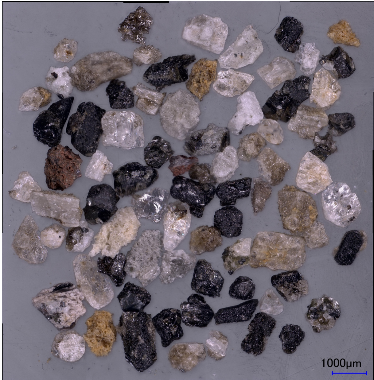
図 2.2.1-2 Aso2016g-E_overview : ACP1(試料番号 Aso2016g-E)から分離した 0.5~1mm 粒子の顕微鏡写真.
