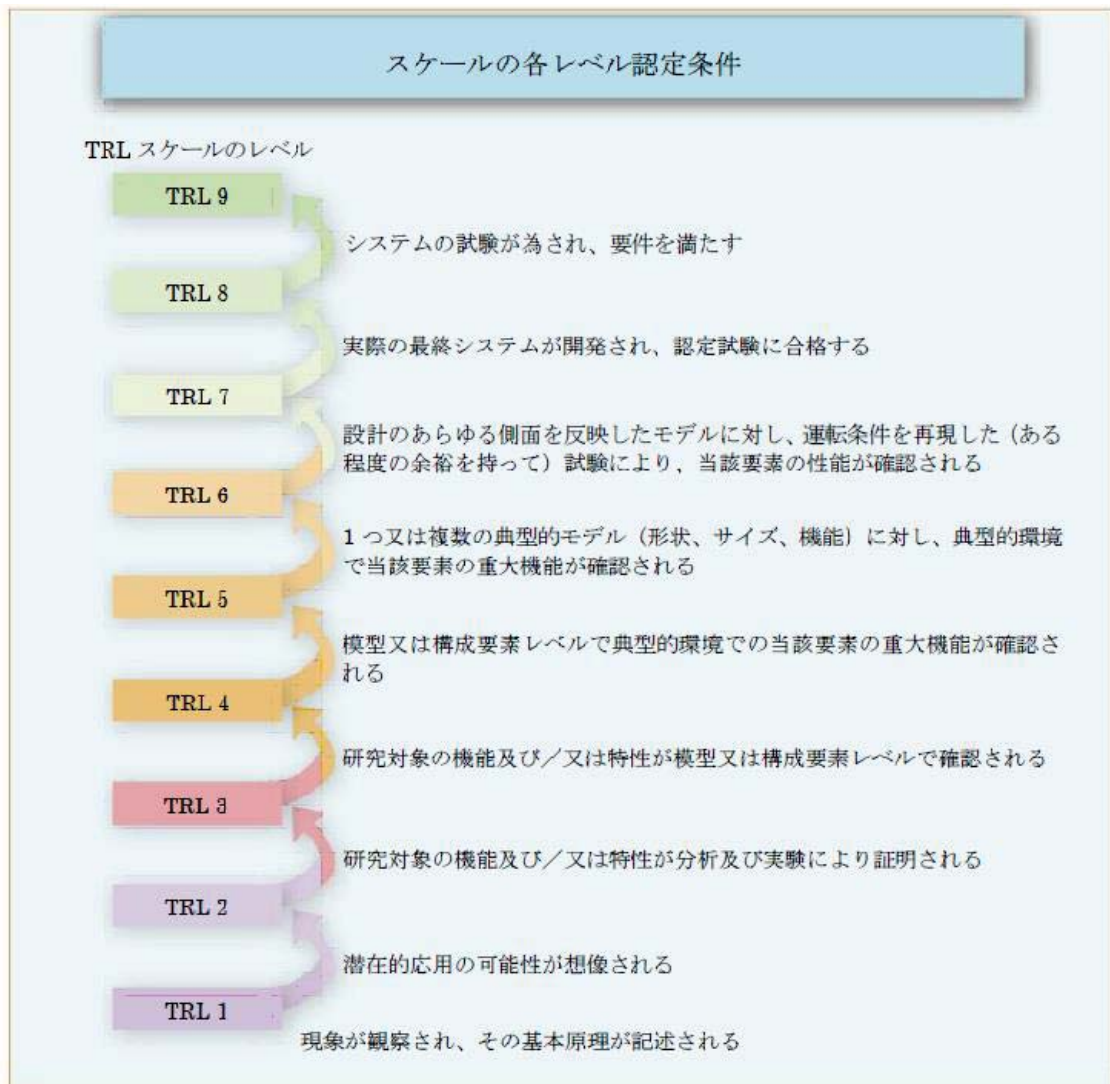
図 6-2 ある要素の技術成熟度を評価するための TRL (ANDRA、地層処分場操業基本計画案 (PDE))
