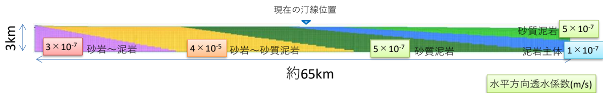
図 3.4-23 地下水流動・塩分濃度解析のための現在の地質構造の設定
