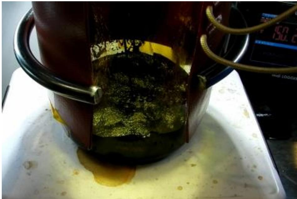
図 A6 加熱中の模擬廃液（試料温度 150℃）
