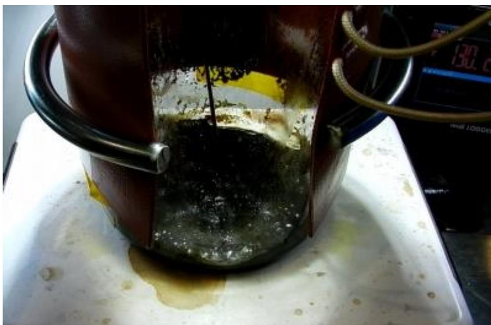
図 A4 加熱中の模擬廃液（試料温度 130℃）
