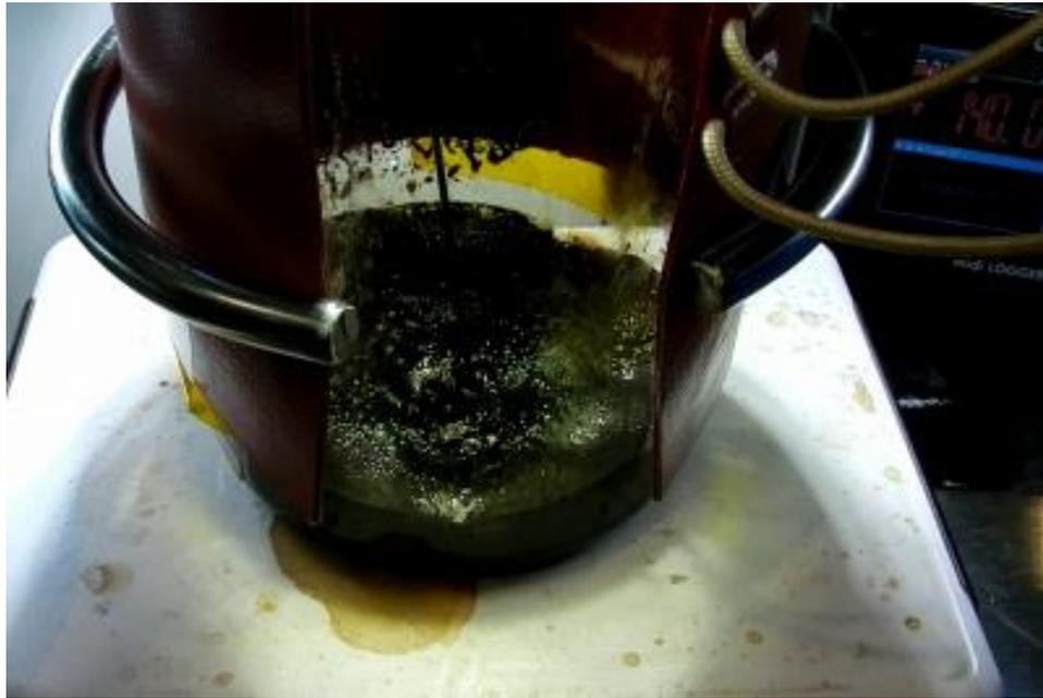
図 A5 加熱中の模擬廃液（試料温度 140℃）
