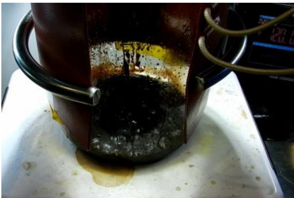
図 A3 加熱中の模擬廃液（試料温度 120℃）
