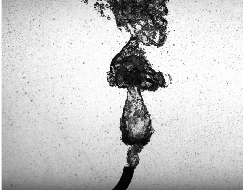
図 3-98 ノズル先端における空気噴流 (ノズル内径 4 mm, 空気流量 50 L/min, 水温 55°C)
