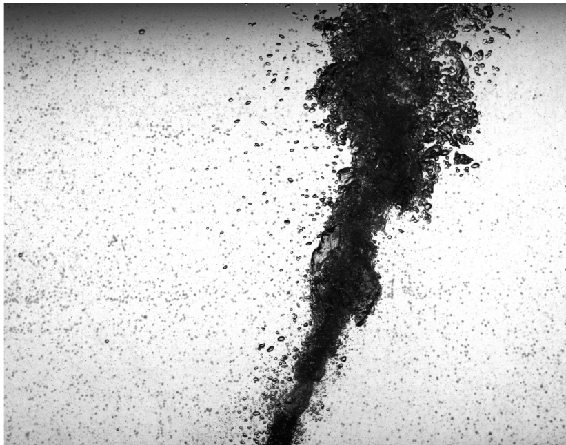
図 3-99 ノズル先端における蒸気-空気混合気相噴流 (ノズル内径 4 mm, 蒸気吐出圧 0.14MPa, 空気流量 50 L/min 水温 55°C)
