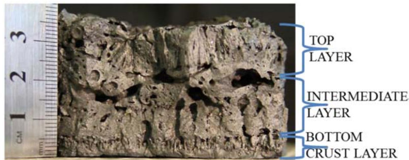
図 3.12 PULiMS E4 実験後の溶融物の縦断面写真
