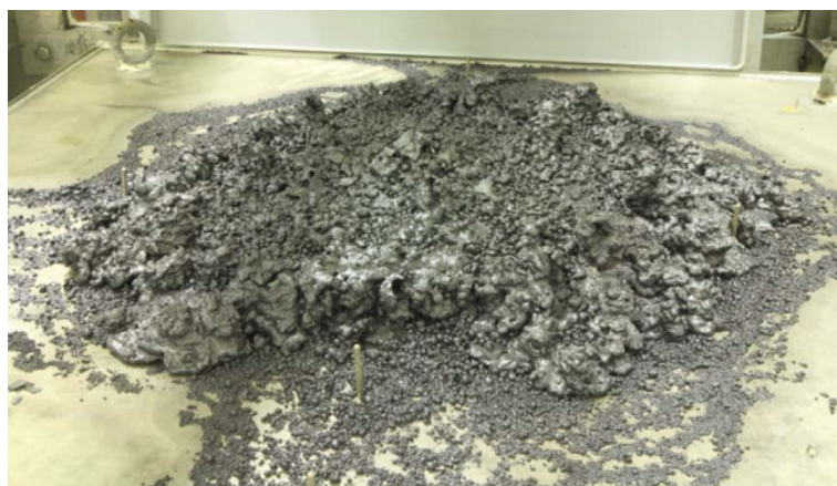
図 3.3 PULiMS 実験の溶融物表面形状（E8 試験）
