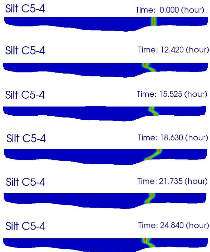
図 3-27 シルトフェンス位置の時間変化 C5-4 (x-z 断面、y=135m)
