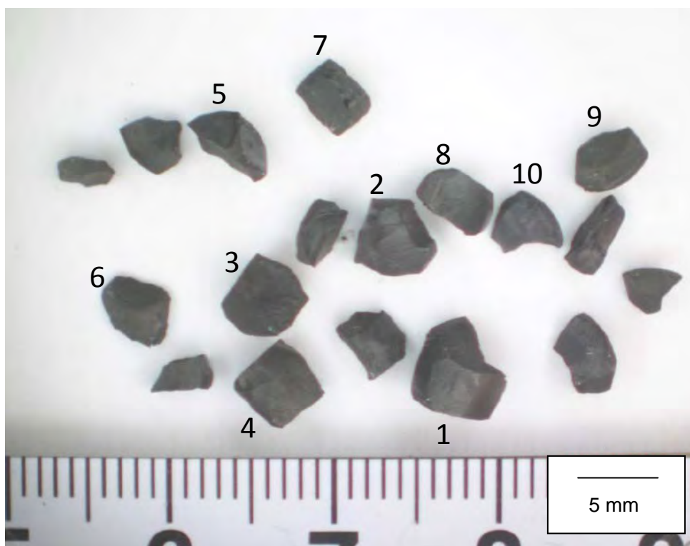
図 3.2-1 採取した燃料ペレット片の外観 (3) (図中数値はペレット片番号)
