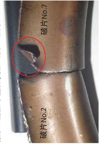
破片端部の軽微な塑性変形（例：破片No. 7）
