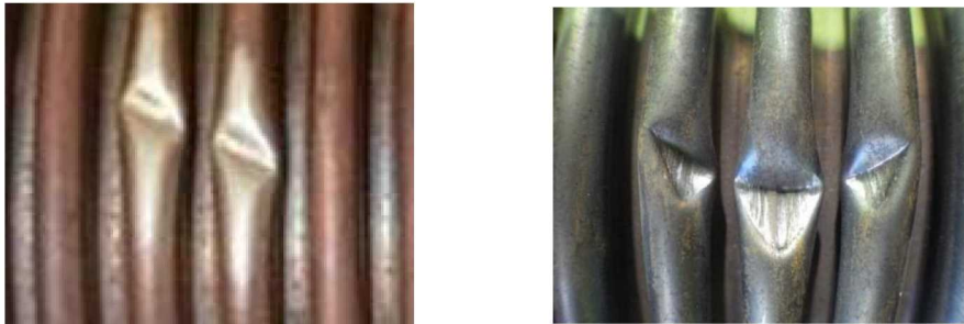
図 55-7 治工具との接触模擬及び排気管伸縮継手の落下模擬による打痕形状の違い
