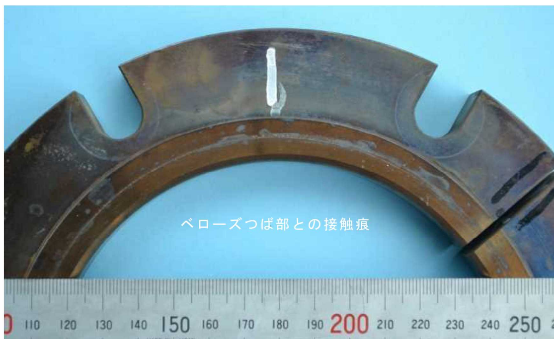
ガス入口側フランジ切断面 ガス入口ー上流側 0° 付近拡大
