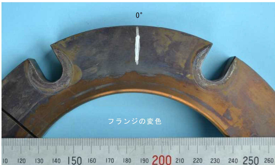
ガス入口側フランジ切断面 ガス入口ー下流側 0° 付近拡大
